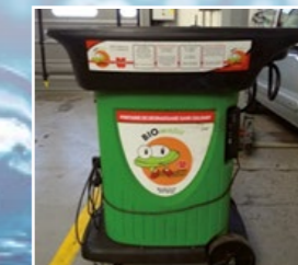
Fontaine de dégraissage biologique
